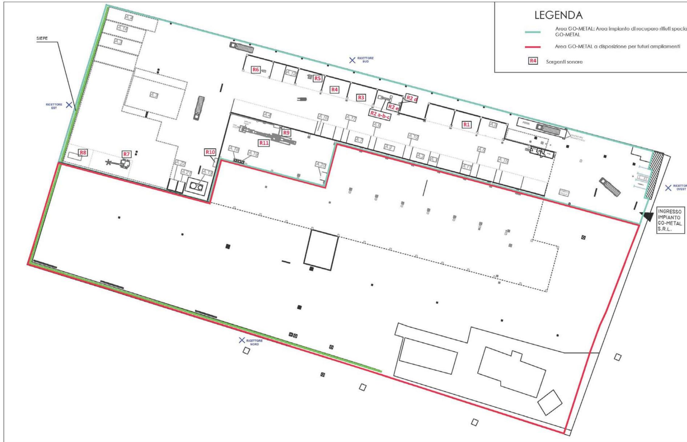
Fig. 20: Planimetria con indicazione delle sorgenti sonore e dei recettori
