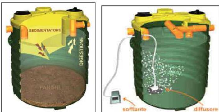
Una volta depurato, il fluido verrà sversato nel pozzetto di controllo esistente sarà collegato alla subirrigazione.
