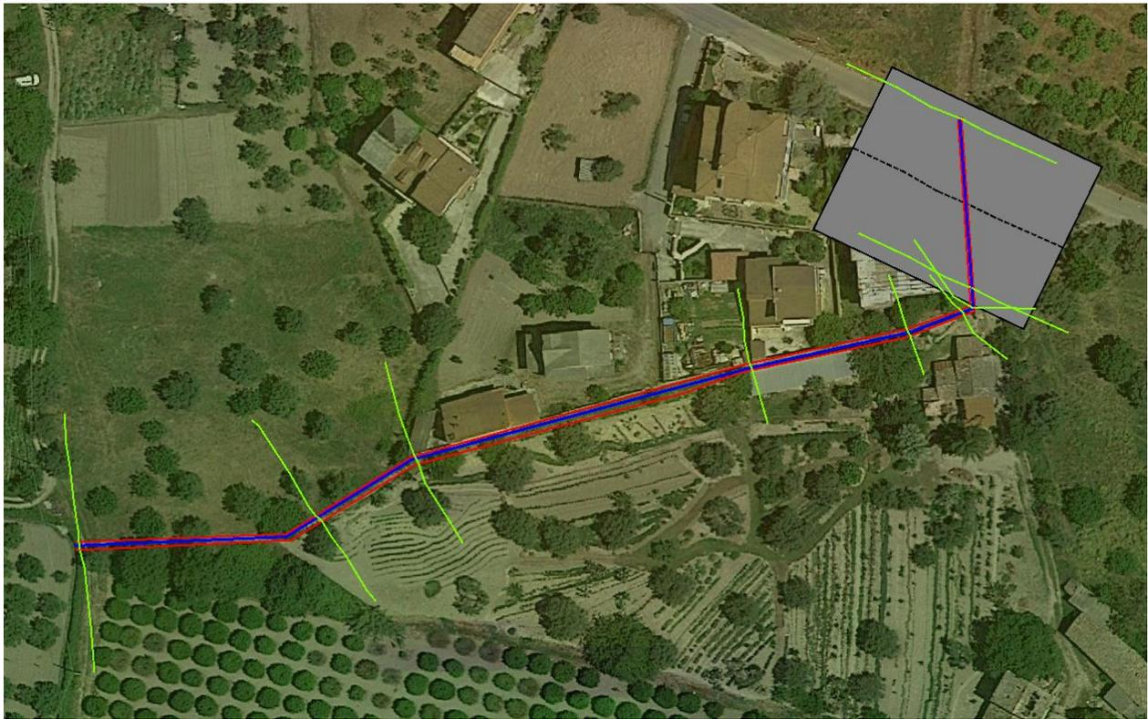
Figura 10 Geometric Data del tratto di canale d'interesse per la modellistica idraulica
