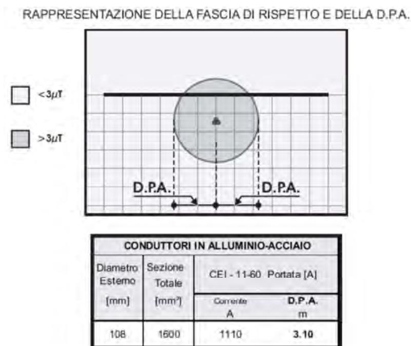
Figura 125. Sezione della linea del cavidotto, in cavo a 150KV.
