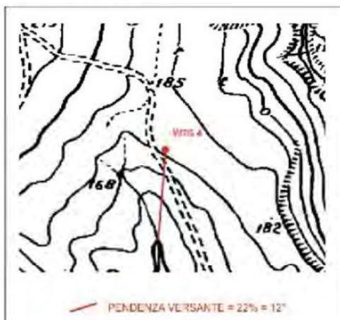
L'area dell'aerogeneratore WTG4 è posta ad una quota di circa 183 m slm, in località Orto Vecchio con inclinazione di circa 12° (22%) con pendenza verso sud.
