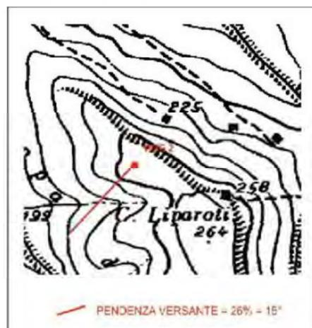
Da quanto rappresentato in figura l'area dell'aerogeneratore WTG2 è posta ad una quota di circa 250 m slm, in prossimità di un locale spartiacque che delimita il fianco nord dal fianco sud del locale rilievo collinare. L'inclinazione del versante sudovest è pari a circa 15° in direzione Sud-Ovest, pendenza 26%.
