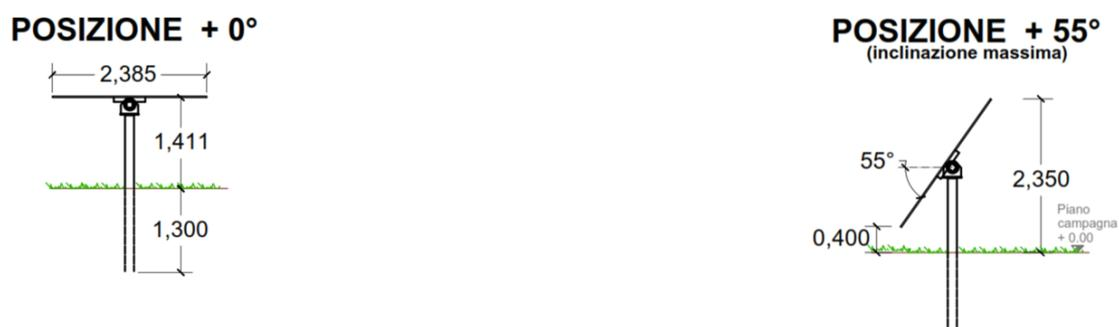
Figura 4.3.1 – Particolare delle modalità di infissione dei supporti dei pannelli nel terreno.
