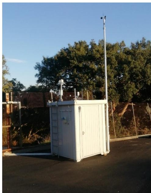
*Figura 6 - Centralina monitoraggio qualità dell'aria*
