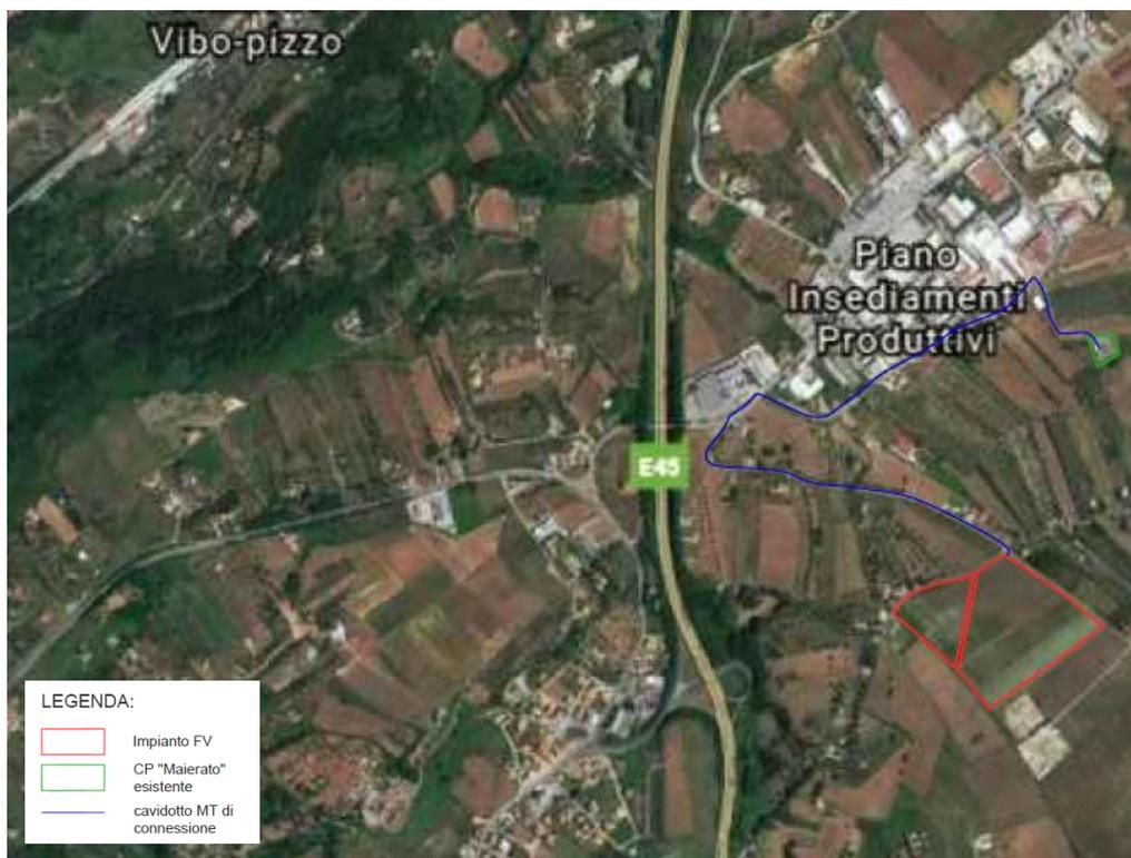
Figura 2 - impianto fotovoltaico "Sant'Onofrio" [stralcio dell' Allegato SRG-SNF-LO-01]
