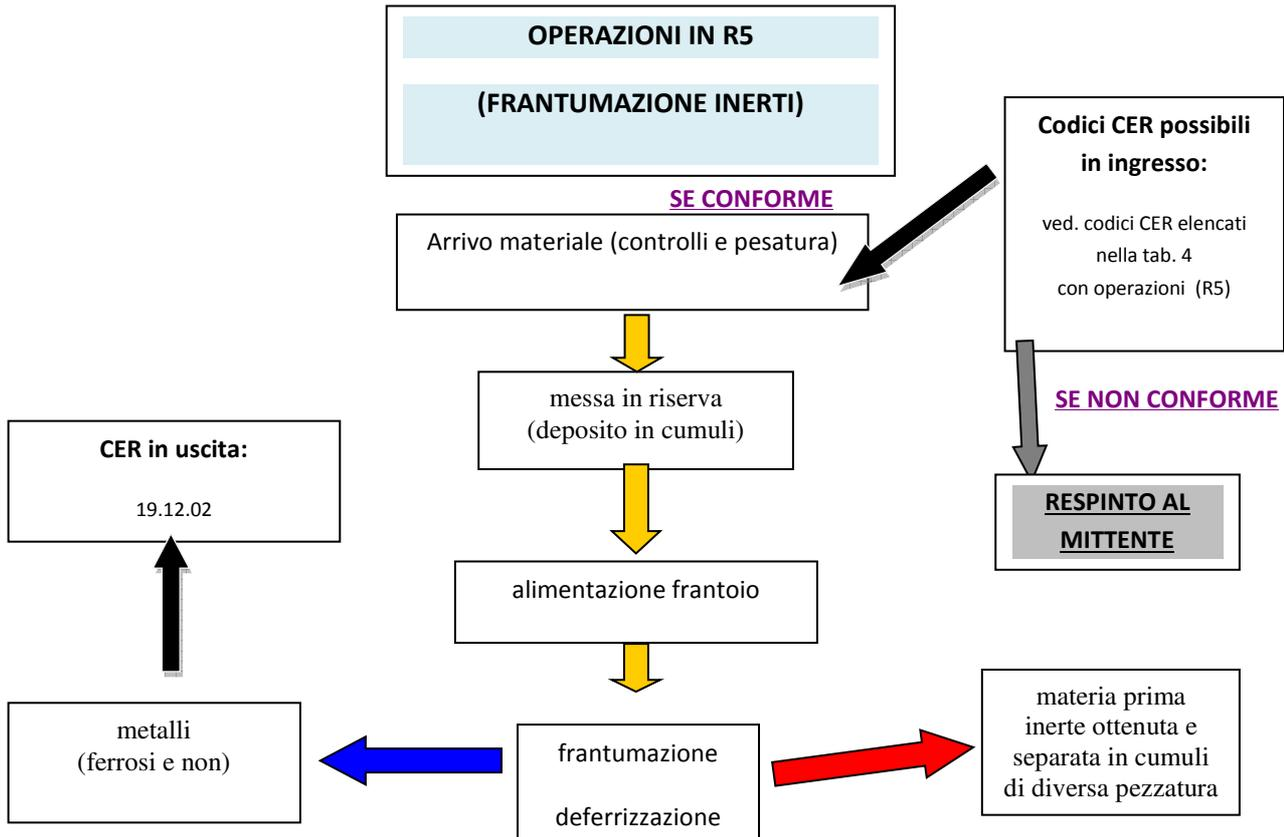
Schema a blocchi del processo di recupero R5 tramite FRANTUMATORE INERTI.
