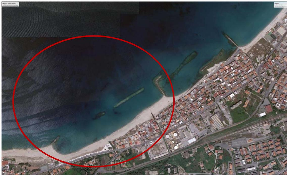
*Figura 4.9 – Andamento del litorale dopo la realizzazione del pennello e della prima barriera (§3.3) - (03-07-2014)*
