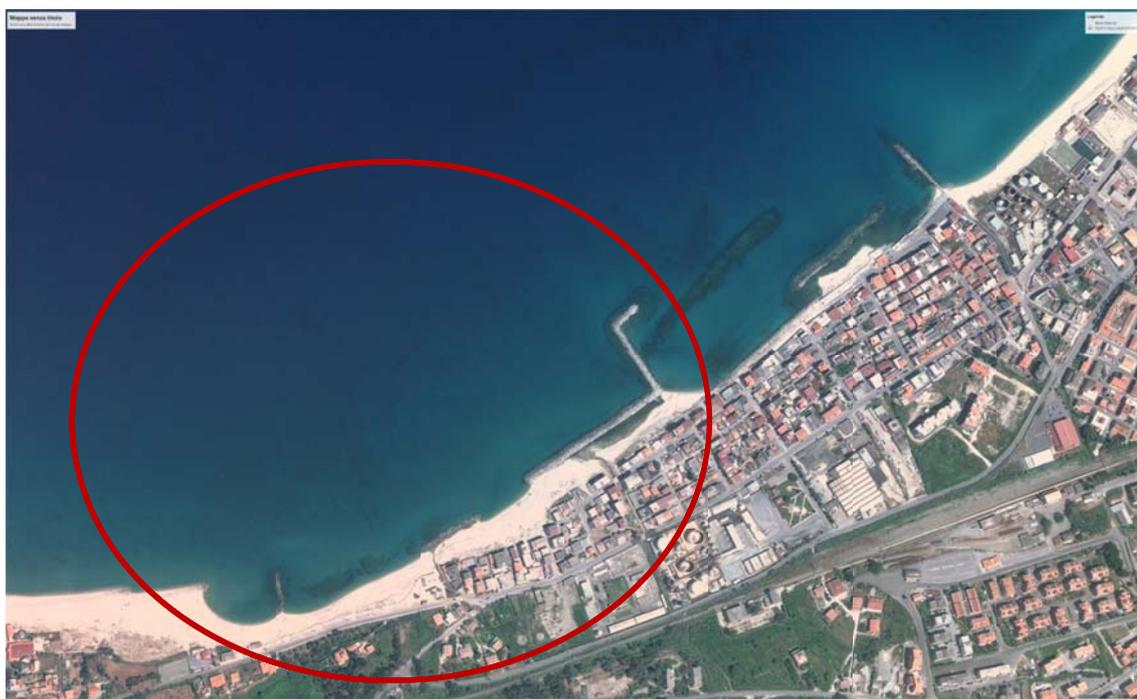
*Figura 4.8 – Andamento del litorale dopo la realizzazione del pennello (§3.2) - (05-02-2010) Si nota che la realizzazione del pennello non ha apportato benefici sull'andamento della linea di riva*
