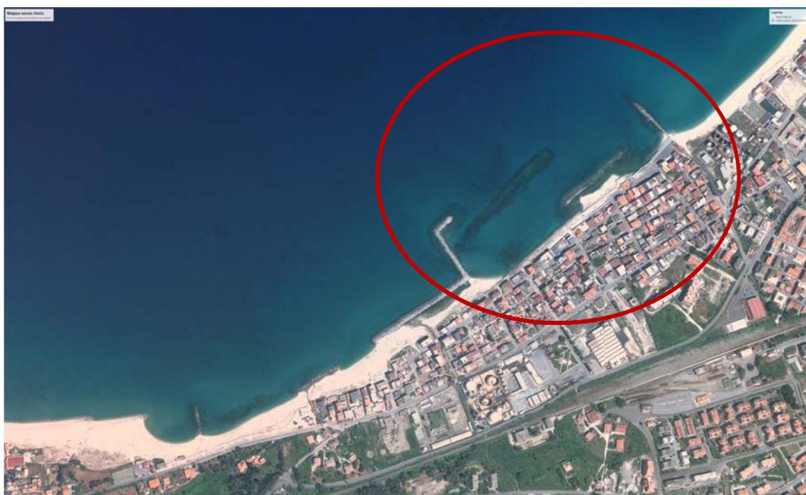
*Figura 4.5 – Andamento del litorale dopo la realizzazione dell'opera (05-02-2010)*
