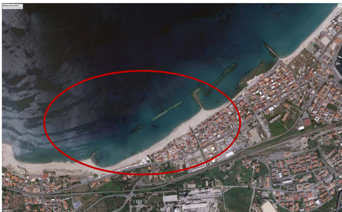
Figura 6.7 – Andamento del litorale al (30-06-2016) – Anche se nel periodo (03.07.2014) – (30.06.2016) non sono state realizzate opere nel tratto in oggetto si nota una stabilizzazione del litorale nel tratto in oggetto.
