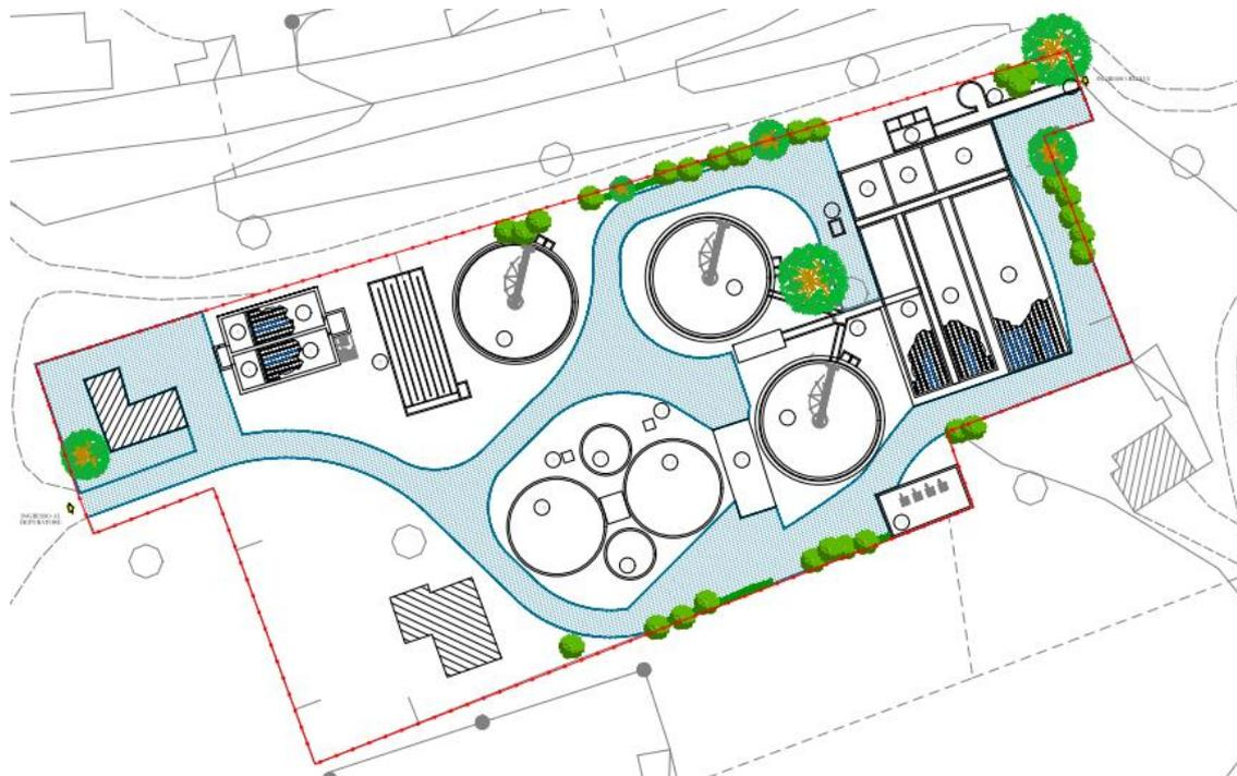
Figura 6 - Planimetria impianto di depurazione stato di fatto
