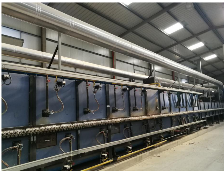
Figura 5 - sistema aspirazione aria centralizzata per abbattimento emissioni
