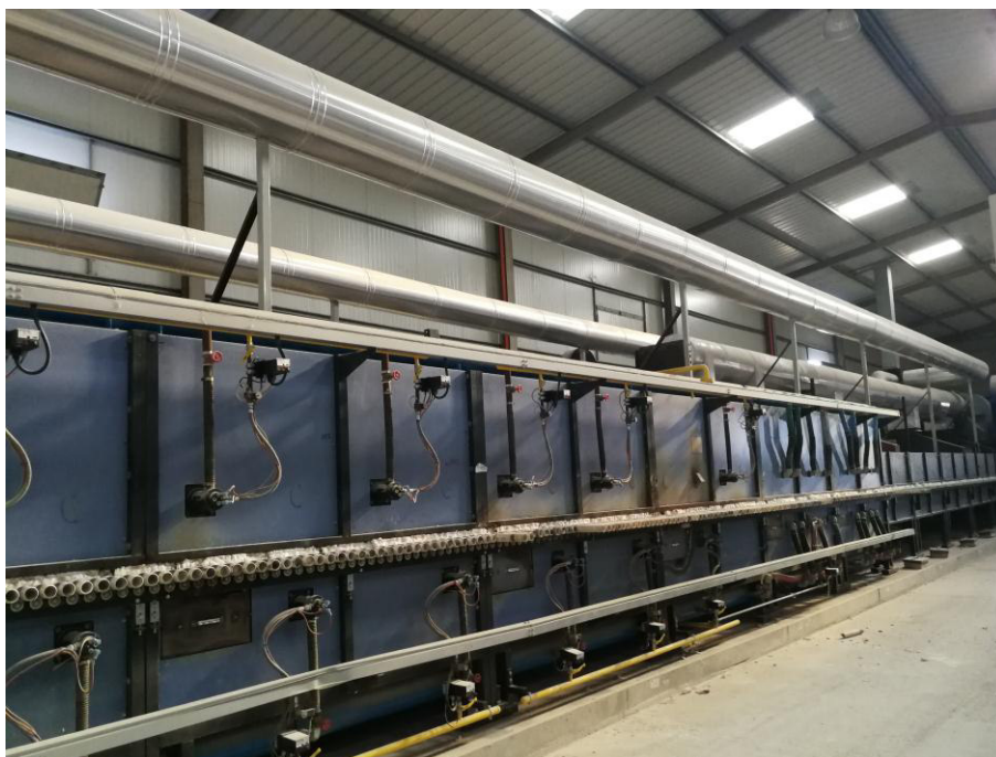
Figura 10 - sistema aspirazione aria centralizzata per abbattimento emissioni
