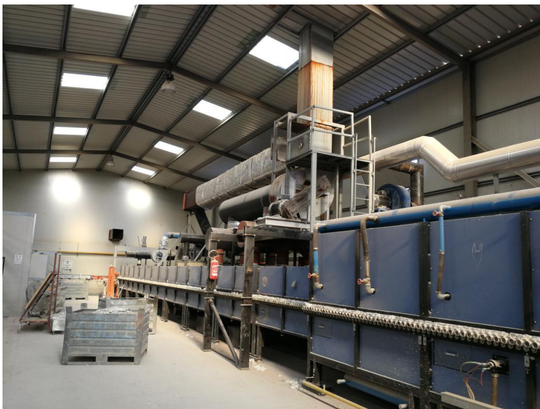
Figura 7 - Punto di emissione fumi del forno
