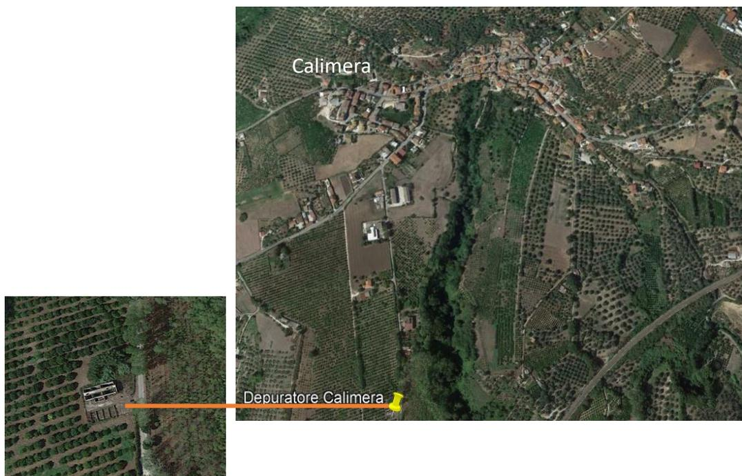
L'impianto di depurazione esistente, in base a quanto riportato nel Documento Preliminare alla Progettazione (DPP), ha una potenzialità di 600 A.E. L'impianto, allo stato attuale risulta completamente abbandonato ed i reflui che vi giungono sono collettati verso valle e scaricati a cielo aperto.
