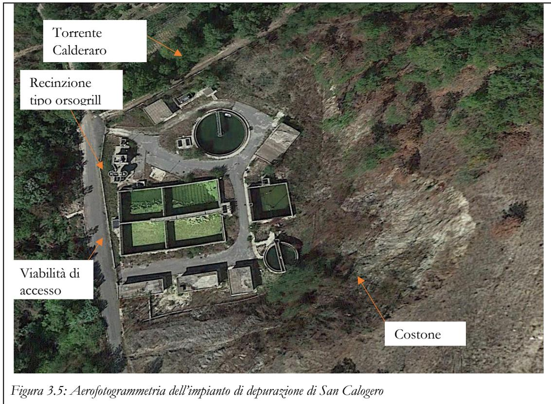
Il costone che sovrasta ad ovest l'impianto presenta problemi di instabilità. Per tale motivo, prima di poter effettuare qualsiasi intervento all'interno dell'area del depuratore, è necessario mettere in sicurezza il versante. Le opere di messa in sicurezza non fanno parte del progetto in argomento.
