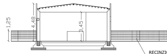
RECINZIONE IN CON MURETTO IN C.A. E PANNELLI GRIGLIATI METALLICI RIVESTITI CON RETE OMBREGGIANTE IN POLIETILENE
