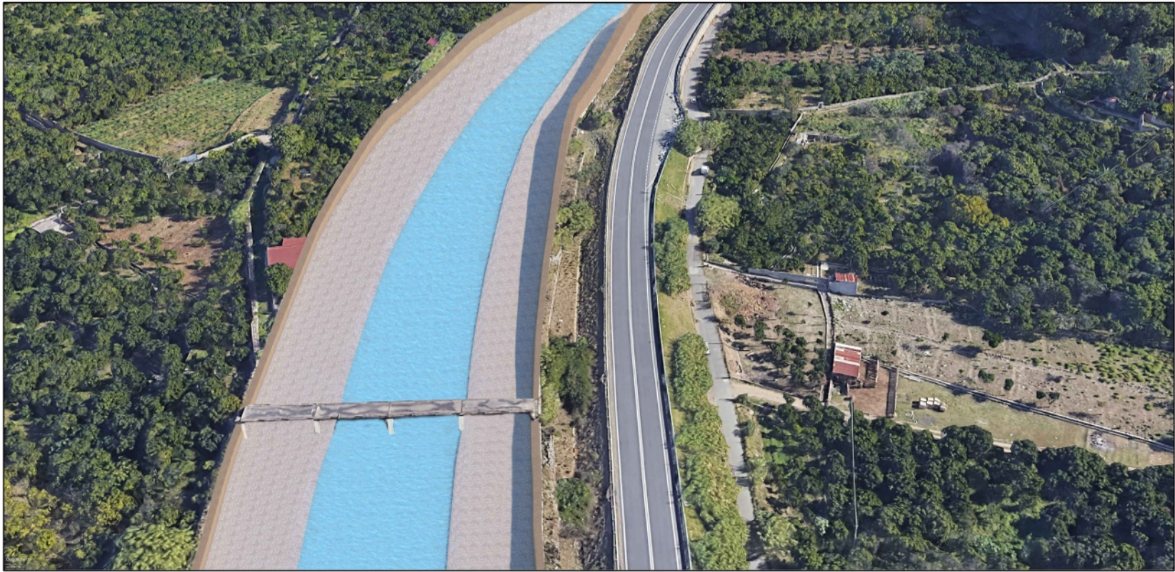
FOTOINSERIMENTO DEL RIVESTIMENTO DELL'ALVEO CON MATERASSI RENO PLUS
