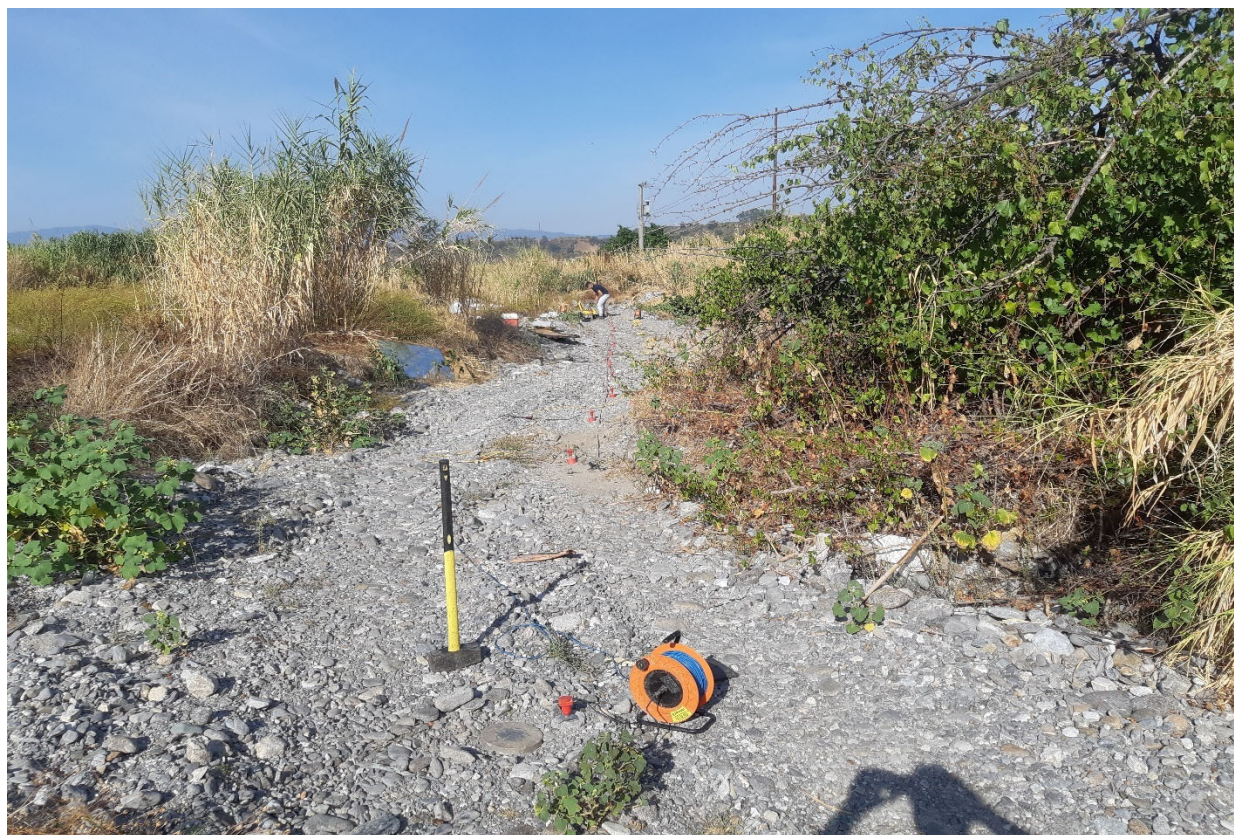
Stendimento sismico masw - LATO EST (geofono n.1)
