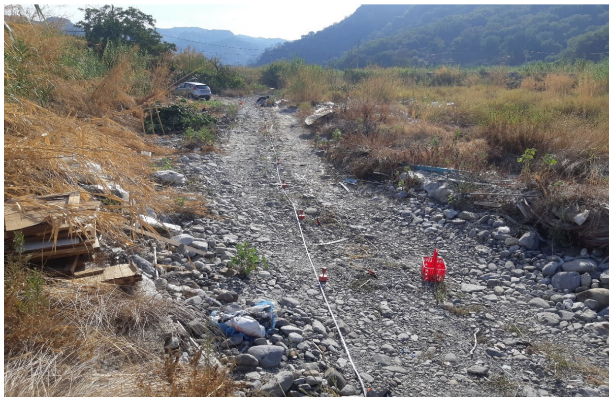
Stendimento sismico masw - LATO OVEST (geofono n.24)
