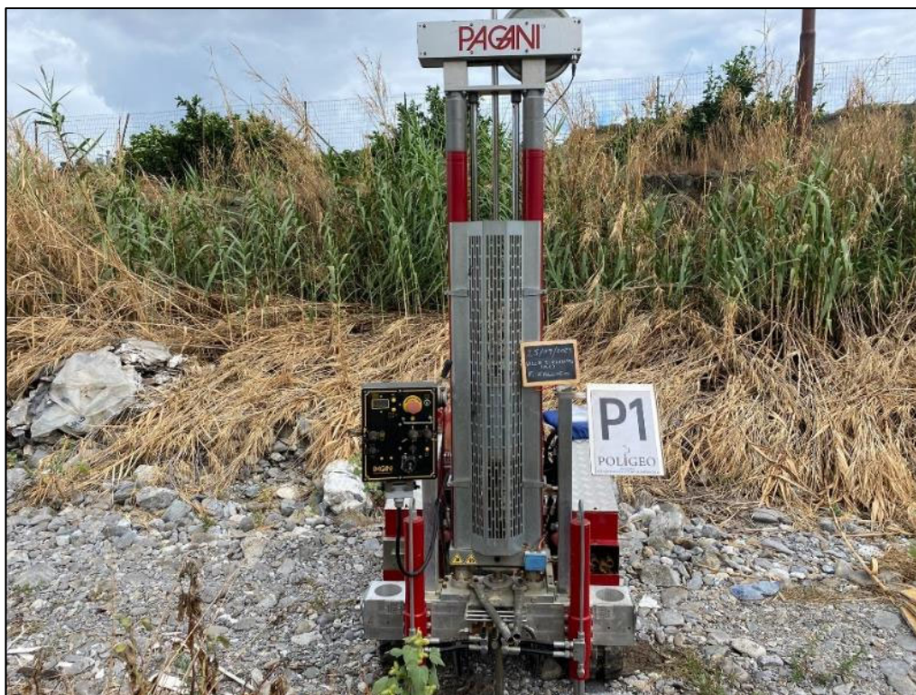
Fotografia 6: posizionamento penetrometro DPSH
