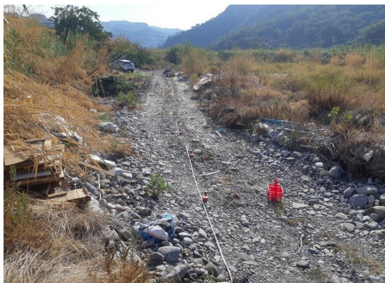
Figura 9-2 stendimento di geofoni per l'esecuzione della prova MASW.
