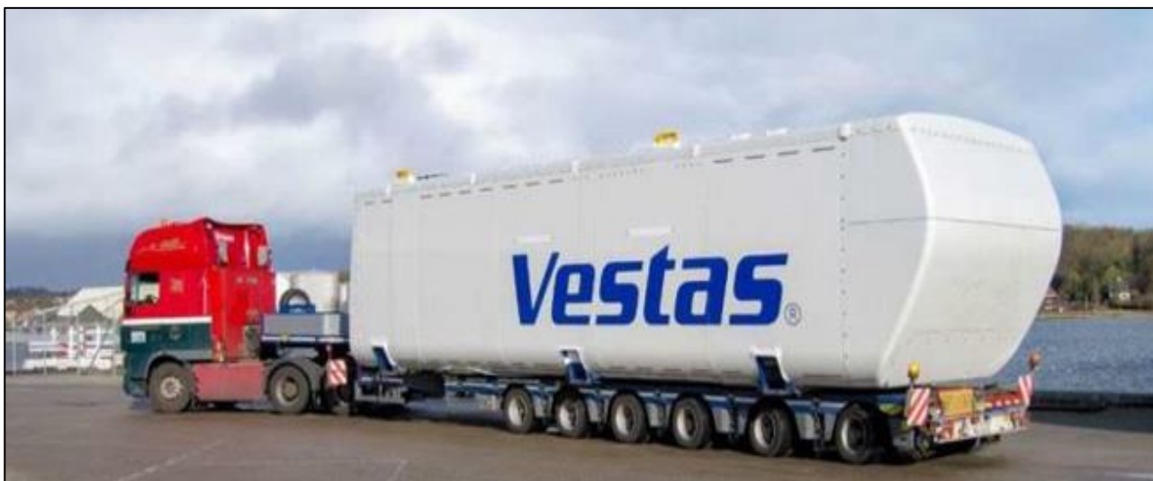
Figura 43. Esempio di mezzi per il trasporto della navicella
