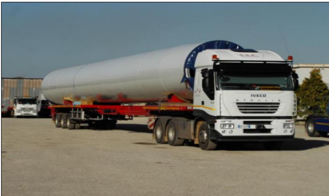
Figura 33. Esempio di mezzi per il trasporto dei conchi di torre
