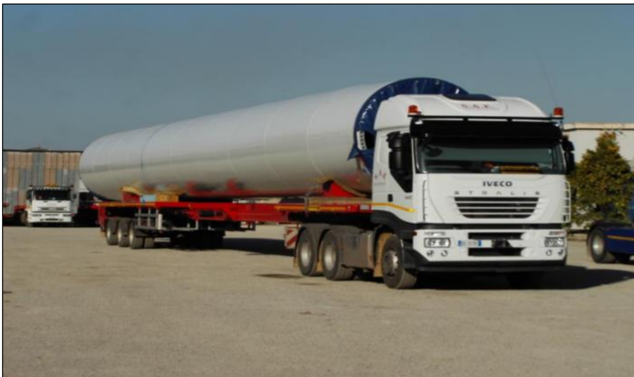
Figura 41. Esempio di mezzi per il trasporto dei conici di torre
