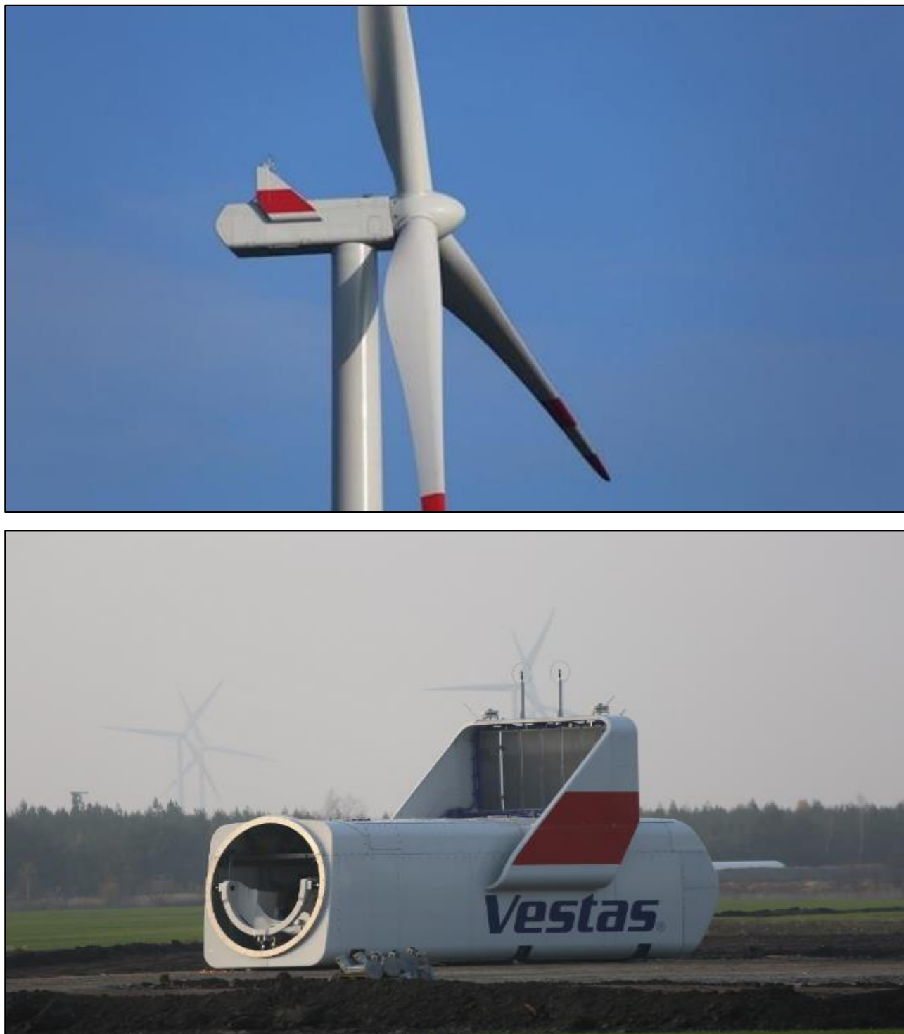
Figura 25. Dettaglio dell'aerogeneratore VESTAS V112
