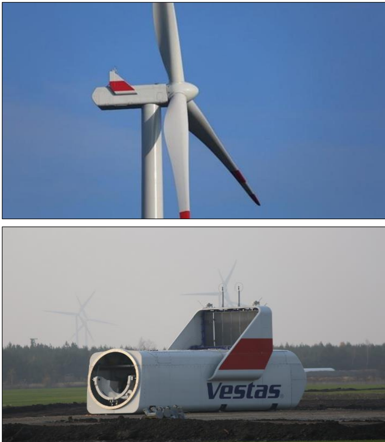
Figura 33. Dettaglio dell'aerogeneratore VESTAS V112
