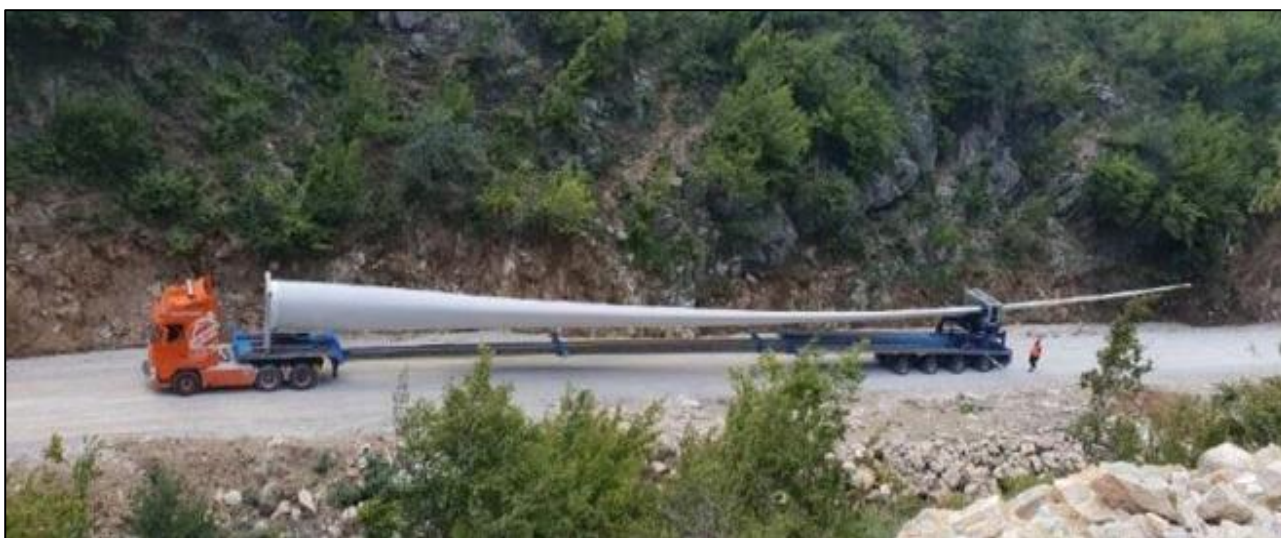
Figura 34. Esempio di mezzi per il trasporto delle pale
