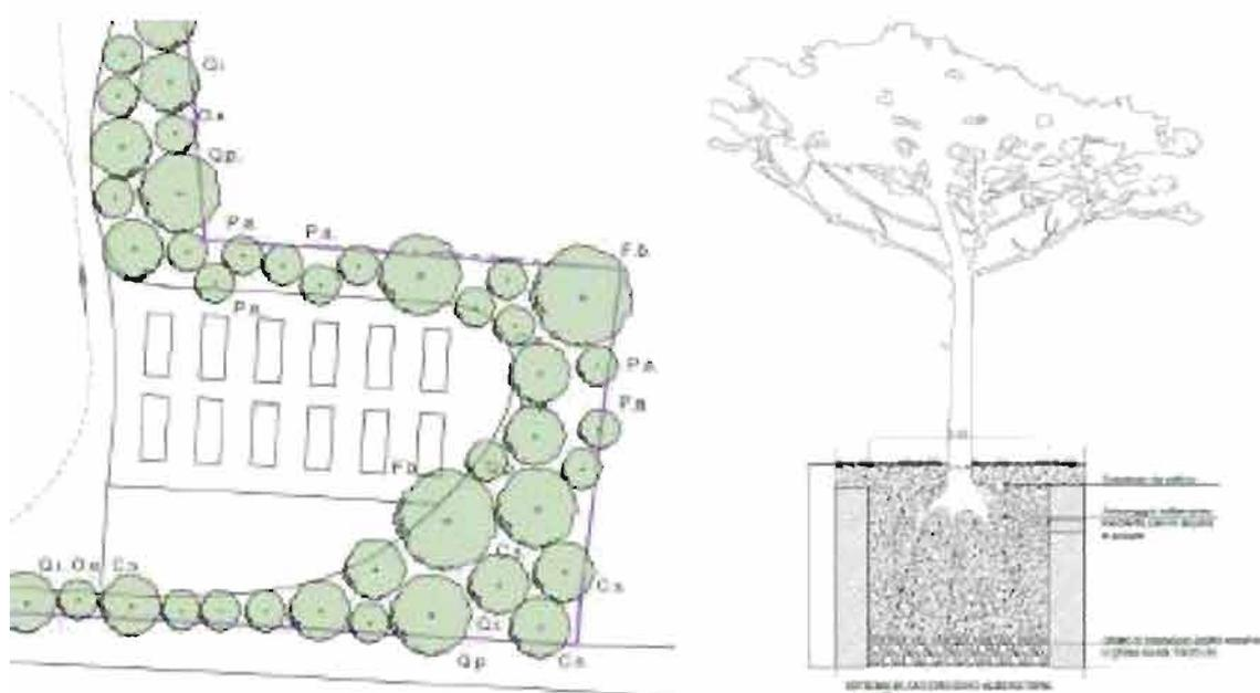
Figura 7 Particolari: sesto d'impianto degli alberi e messa a dimora con ancoraggi
